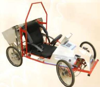
*Elektromobil riadený mikrokontrolérom s elektronickým diferenciáлом*
